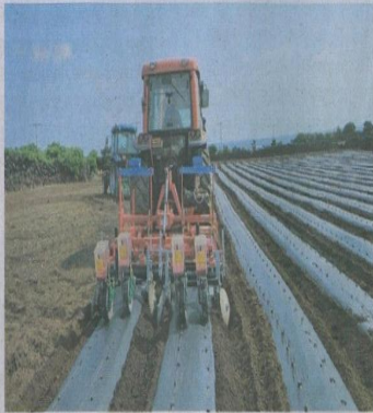
제주농업기술원은 땅콩 파종방법 개선으로 수확작업의 기계화를 위해 기능성 땅콩 기계화 생산단지 조성 시범사업을 추진한다고 밝혔다. 사진은 두줄 파종방식으로 개선한 땅콩 파종 모습.
